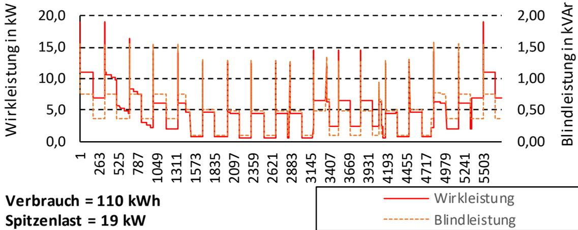
Abbildung 6: Notstromlastprofil FF Feldbach für einen Sommertag
