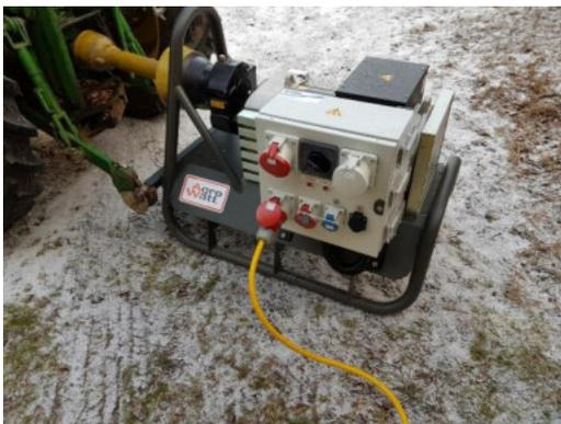
**Zapfwellengenerator + Motor vom Traktor**
