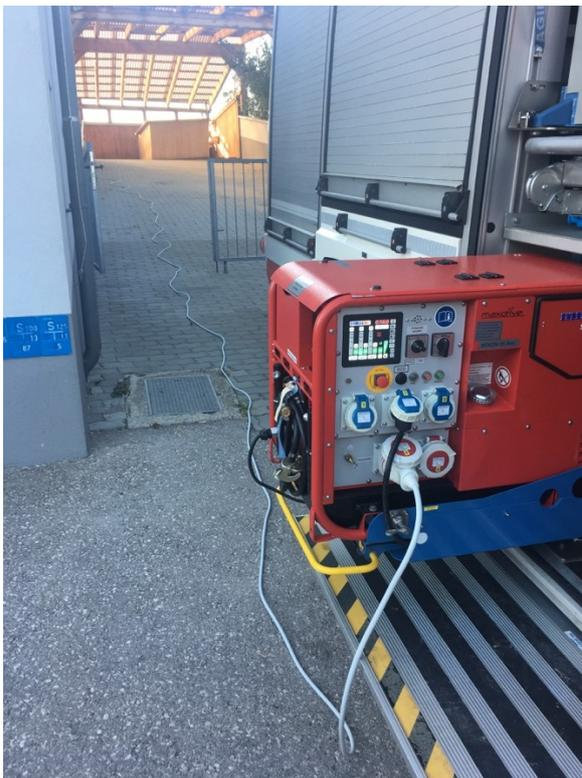
Abbildung 16: Stromerzeuger Endress mit angestecktem Einspeisekabel. (Quelle: FEUERWEHR OLLERN 2018)
